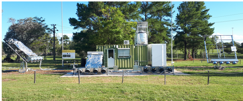
Fig. 2: Solar Heater Test Bench (BECS) at the Solar Energy Laboratory, Universidad de la República, Salto, Uruguay.
