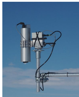
HYPSTAR® system [Kuusk et al, 2024] 380-1680nm, 3-10nm FWHM
