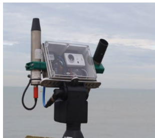
PANTHYR system [Vansteenwegen et al, 2019] 400-900nm, 10nm FWHM
