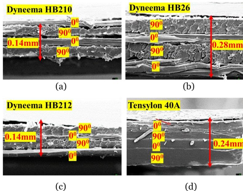
Figure 1: SEM images of (a) Dyneema HB210 (b) Dyneema HB26 (c) Dyneema HB212, and (d) Tensylon 40A
