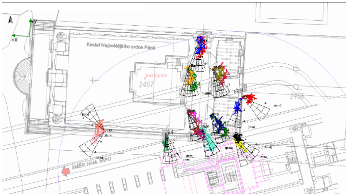
Obrázek 7: Vějíře se směrem vývoje deformací na polohopisných bodech na fasádě kostela (vždy dva body nad sebou, naklonění vztaženo k terénu)
