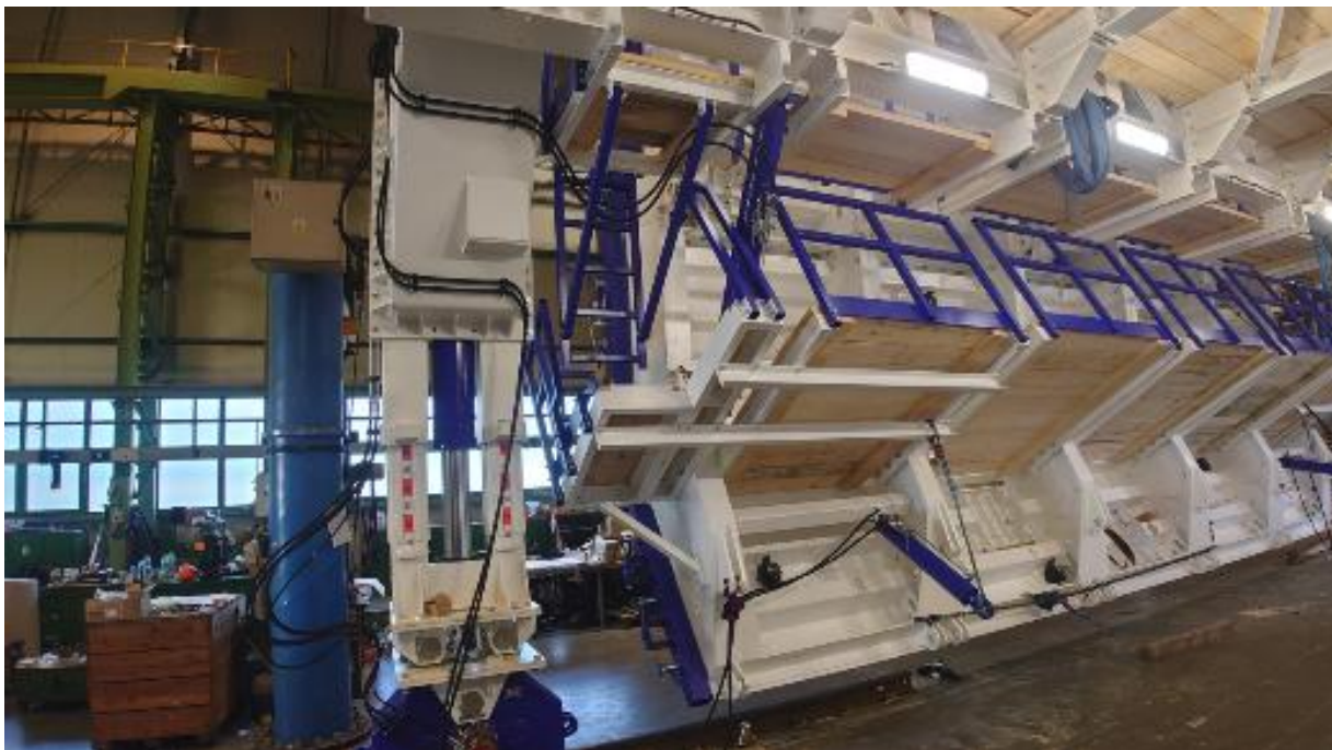
Obrázek 10: Kontrolní montáž zařízení
