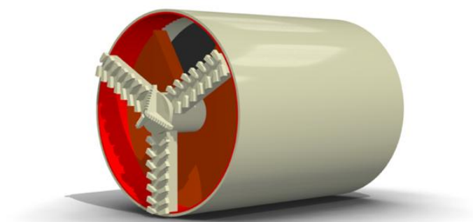
Obrázek 4: Vizualizace zeminového štítu (Tokyo 1974)
