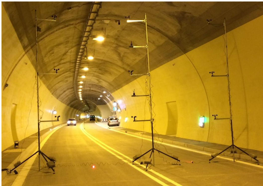
Obrázok 4: Sieťové merania prúdenia vzduchu v tuneli Poľana
