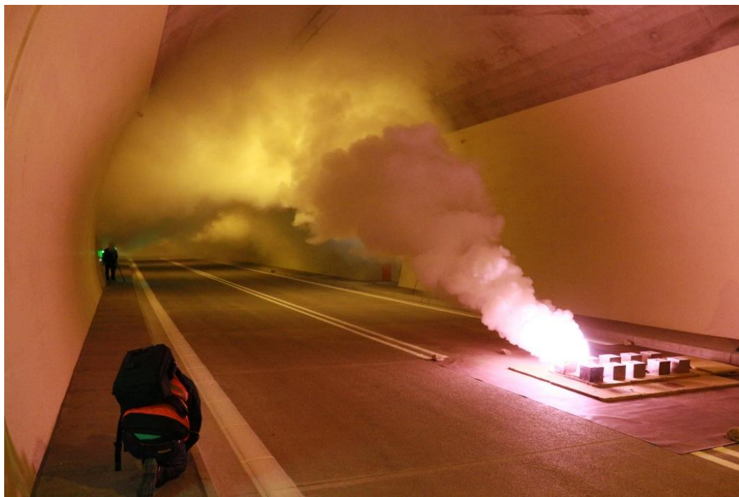
Obrázok 5: Experiment in situ (tunel Poľana) so studeným dymom – aerosólom
