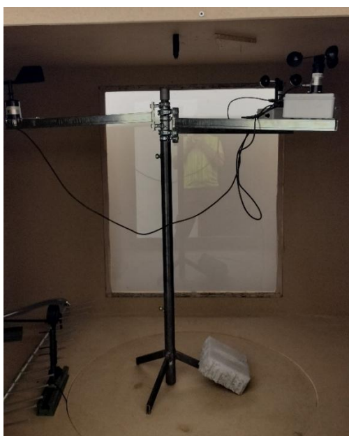
Obrázok 9: Test anemometrov a smerovníka vo veternom tuneli
