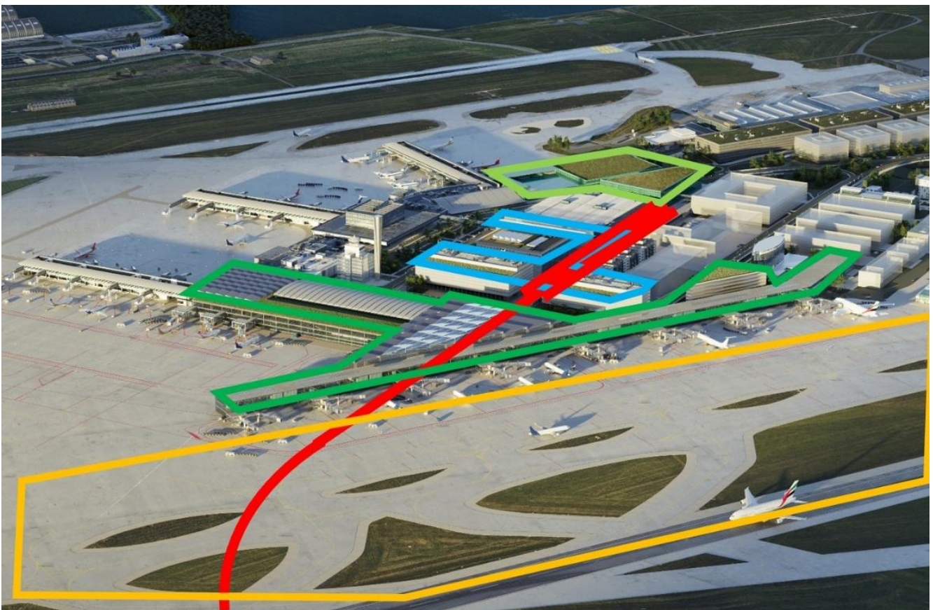
Obrázek 1: Vizualizace modernizace LVHP (červeně – železniční projekty, modře – parkovací domy, oranžově – nová vzetová a přistávací dráha, zeleně – rozšíření Terminálu 1 a 2)
