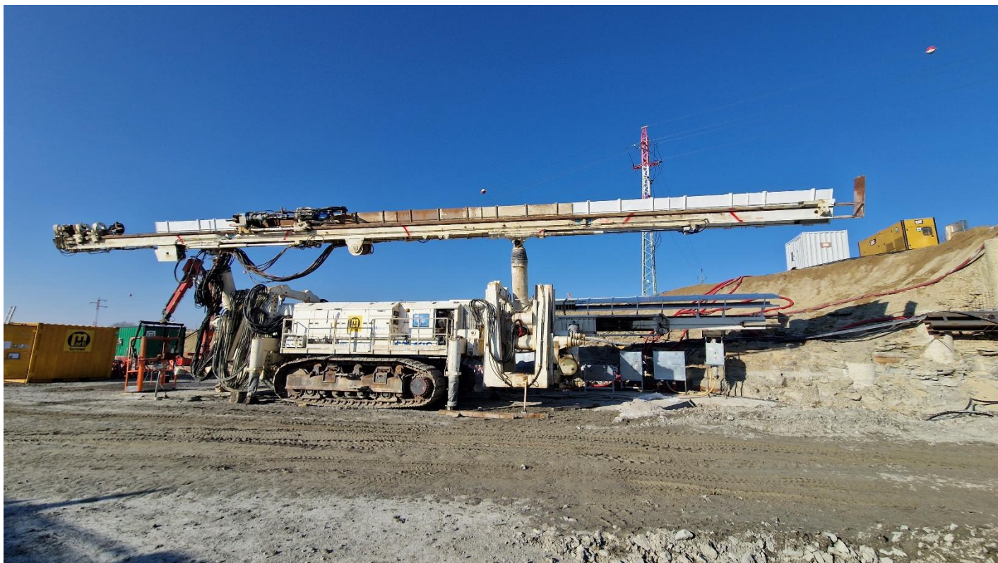
Obrázek 5: Stroj pro realizaci mikropilotových deštníků
