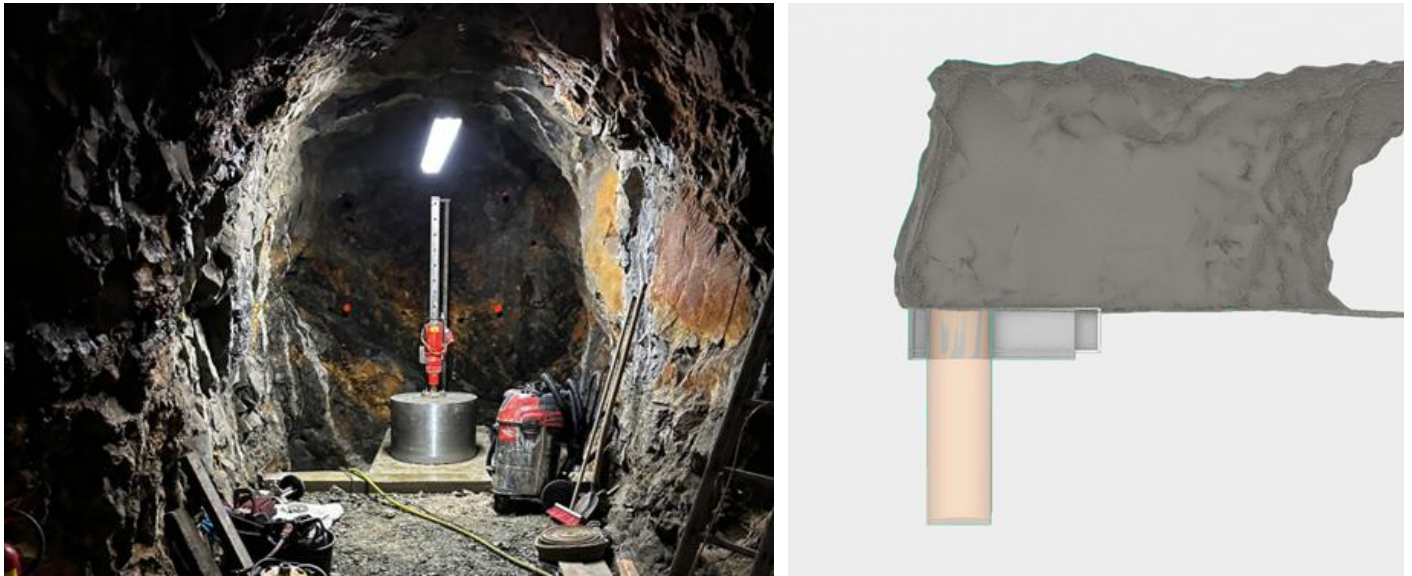
Obrázek 6 – Vlevo je foto při realizaci vrtu pro experiment projektu INTES a vpravo je koncepční návrh experimentu, kde by budou testovány odpadní materiály ze sléváren pro ukládání energií.
