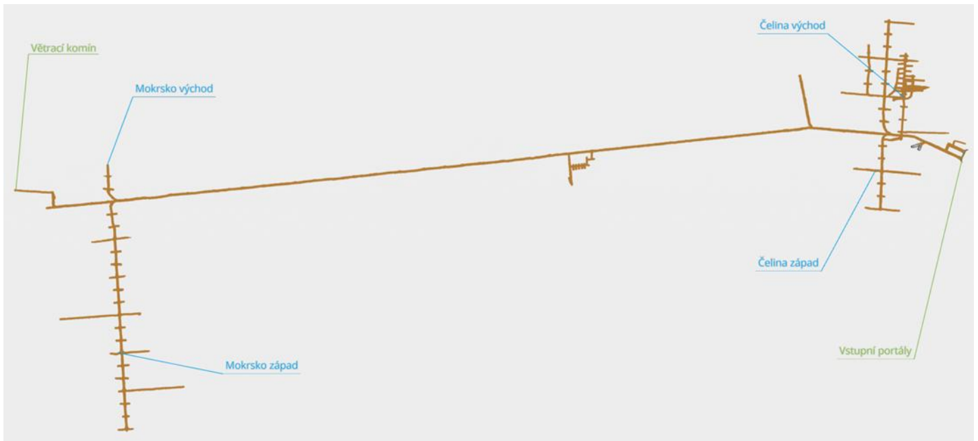
Obrázek 2 – Půdorysný řez z nového georeferencovaného 3D modelu štoly Josef. Z 8 km je provozováno zhruba 6 km podzemních prostor. Z původního důlního díla tedy není zprovozněno zhruba 2 km v oblasti ložisko Mokrsko-východ.
