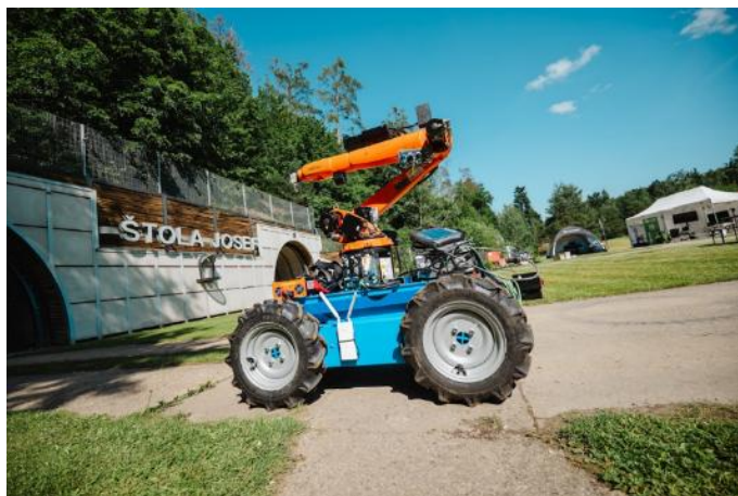
Obrázek 7 – JULBOT ver 1.0 – robustní stroj určený pro výuku, výzkum a vývoj v oblasti automatizovaného monitoringu nejenom podzemních staveb.
