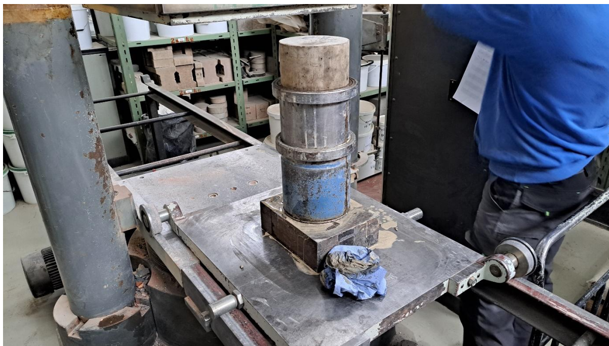
Obrázek 4: Uspořádání testu zhutnění betonové směsi tlakem
