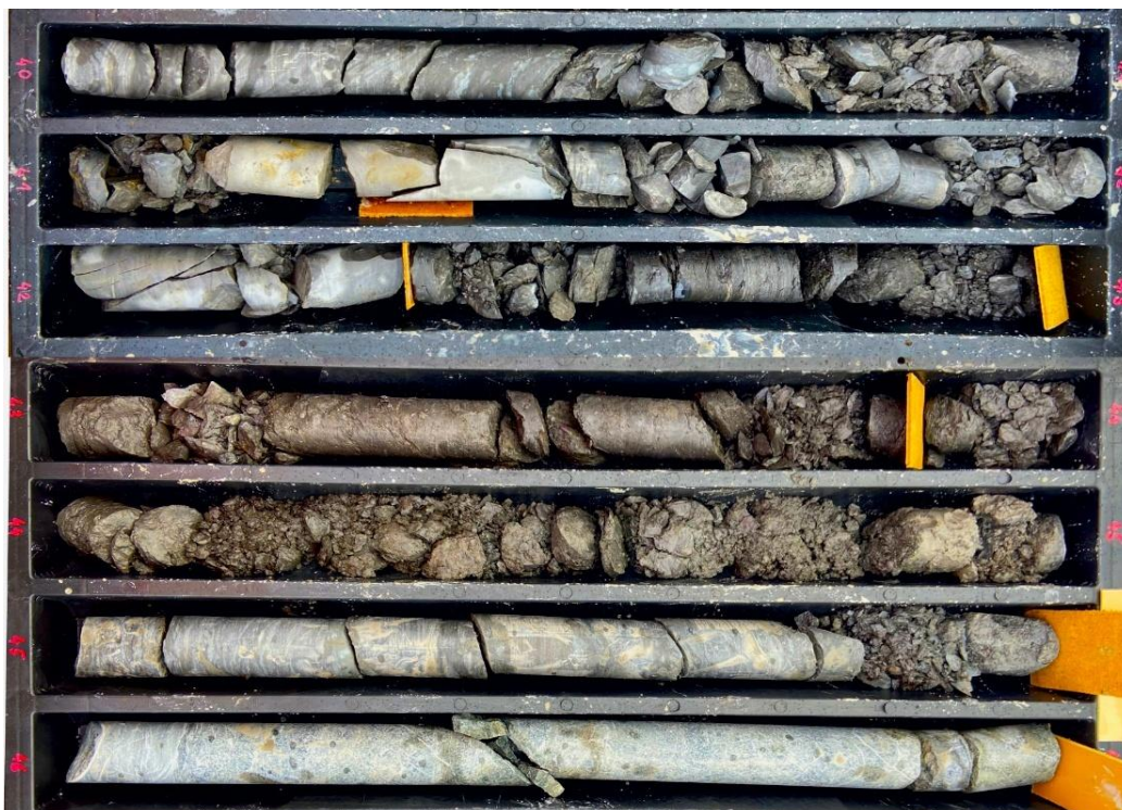
Obrázek 3: Zastižení tachlovického přesmyku ve vrtu J30, hloubkový úsek 40–47 m. V nadloží poruchové zóny se nacházejí starší břidlice a křemence kosovského souvrství (ordovik), v podloží byly zastiženy mladší břidlice a bazalty motolského souvrství (silur).
