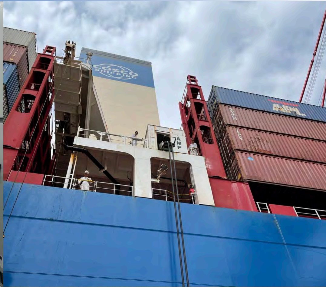
岸基供电连船作业
