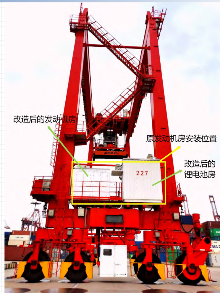
轮胎吊锂电池柴油混合动力改造
